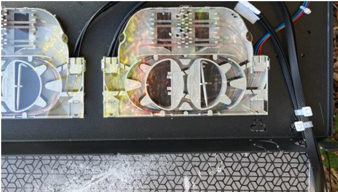
Installation multifibre pour instrumentation poutre béton - EDF
