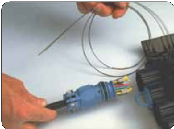
Figure 6.14 : entrée de câble par kit mécanique
