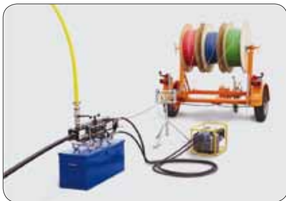
Figure 5.13 : système de pose de micro-tubes par soufflage
