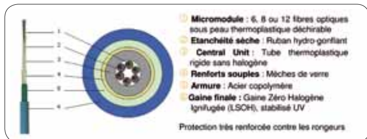
Figure 4.20 : structure d'un câble tunnel / métro
