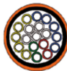
Figure 4.12 : assemblage de micro-tubes avec gaine de protection
