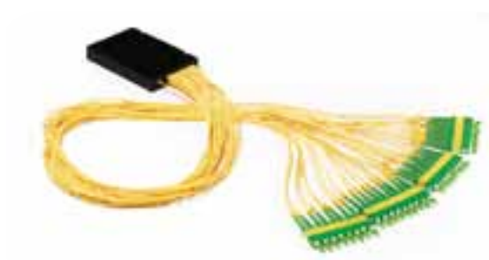
Figure 4.56 : coupleur 1x32 en boîtier avec gaine 2mm sans dispositif d'intégration
