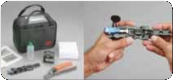
Figure 4.48 : outillages de montage des connecteurs montés terrain
