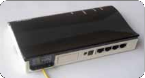
Figure 7.1 : CPE susceptible de supporter quatre opérateurs de services indépendants
