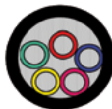
Figure 4.8 : section d'un fourreau PeHD avec micro-tubes indépendants
