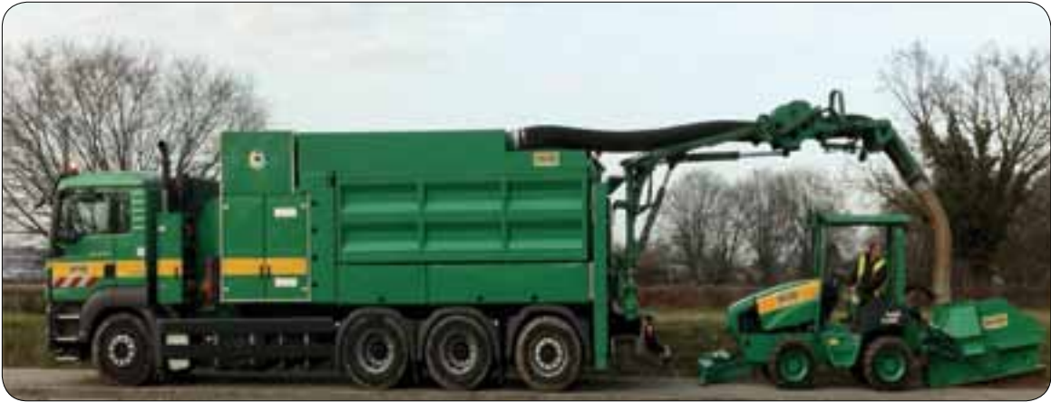
Figure 5.12 : atelier de micro-tranchage en action
