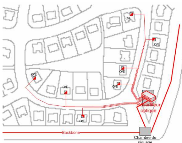
Figure 3.9 : architecture FTTH point à point
