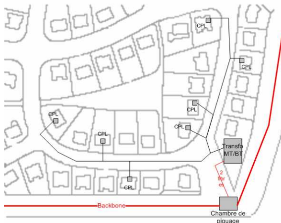
Figure 3.7 : architecture Ethernet à terminaison CPL
